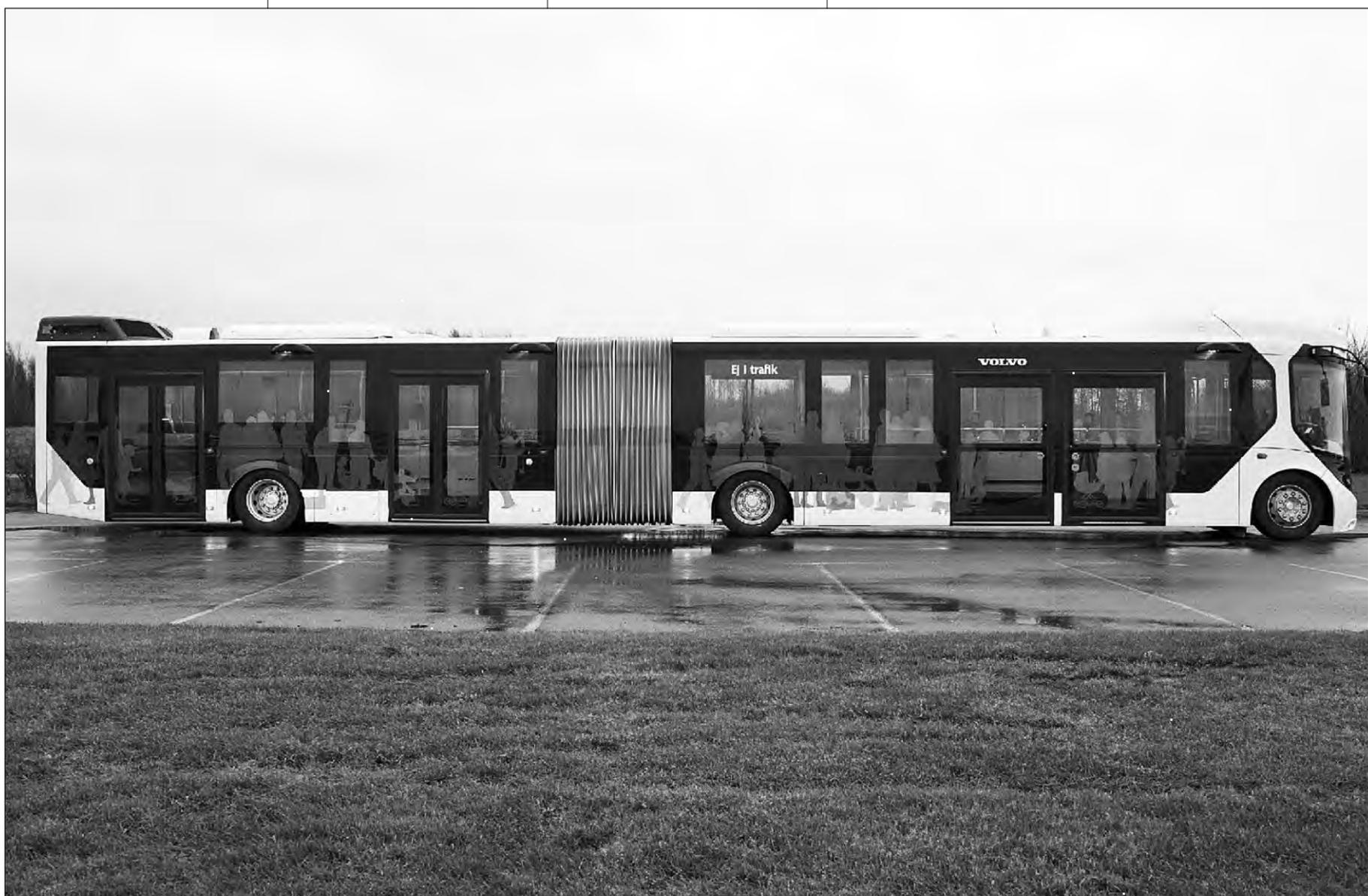
Un mayor número de puertas de gran anchura es la seña de identidad de algunos de los prototipos desarrollados por EBSF. Este modelo, fabricado por Volvo y probado en Gotemburgo (Suecia), tiene una configuración revolucionaria, con la cabina del conductor centrada y la primera puerta, doble y muy amplia, situada a continuación de las ruedas delanteras.
